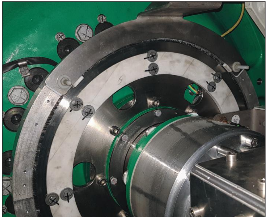
Après l'installation des bagues AEGIS® PRO, la tension de l'arbre a été réduite à moins d'un volt.
